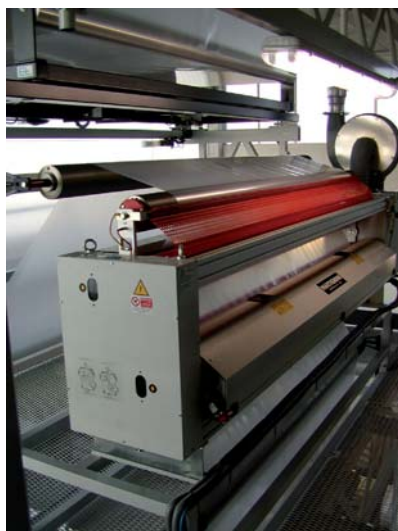
A sinistra: l'unità di trattamento corona A destra: dispositivo di misura dello spessore
