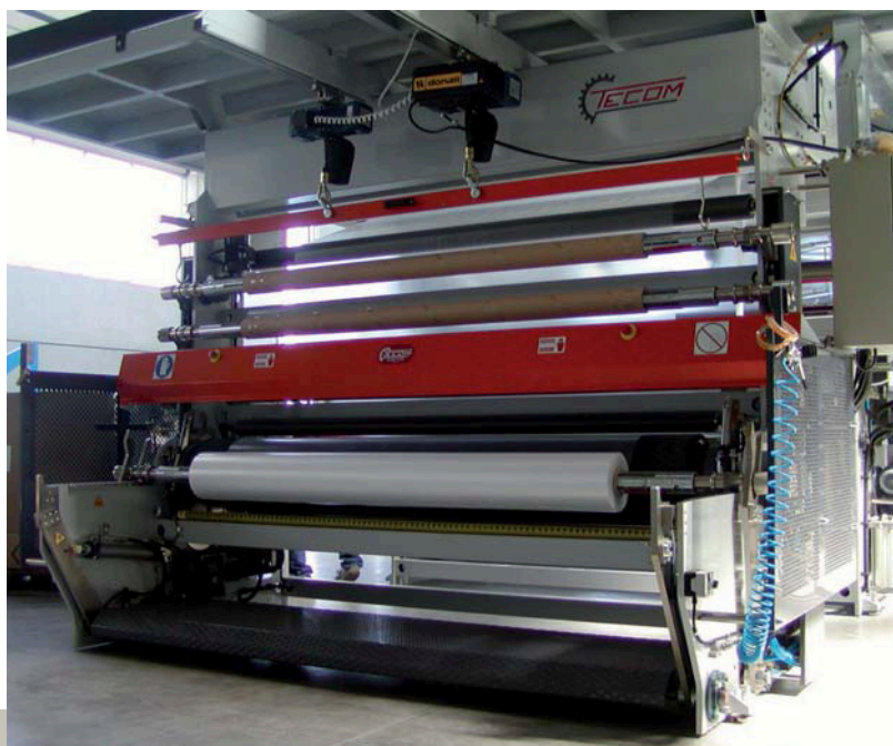
The Tecom blown film plant winding system Das Wickelsystem bei der Tecom Schlauchfolienanlage
